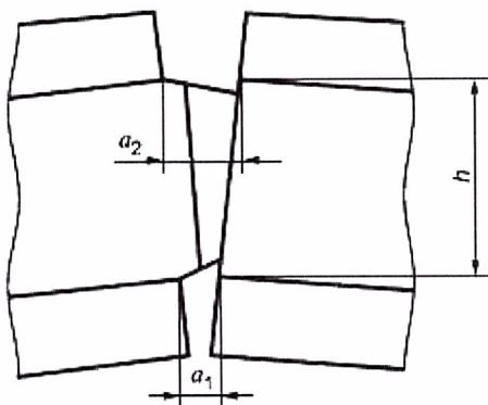
$a_1$  - ширина зазора по kleевому соединению ящика, измеренная снизу;
