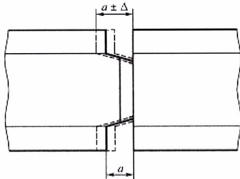
$a$  - ширина зазора по kleевому соединению ящика
